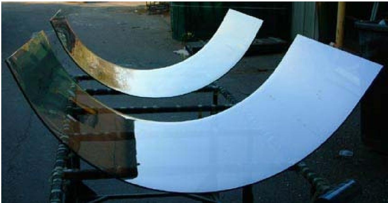
经热弯的皮尔金顿 Eclipse Advantage™反射 Low-E 玻璃
